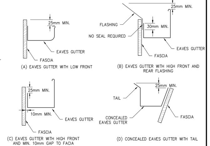
**EAVES GUTTER OVERFLOW METHODS**
