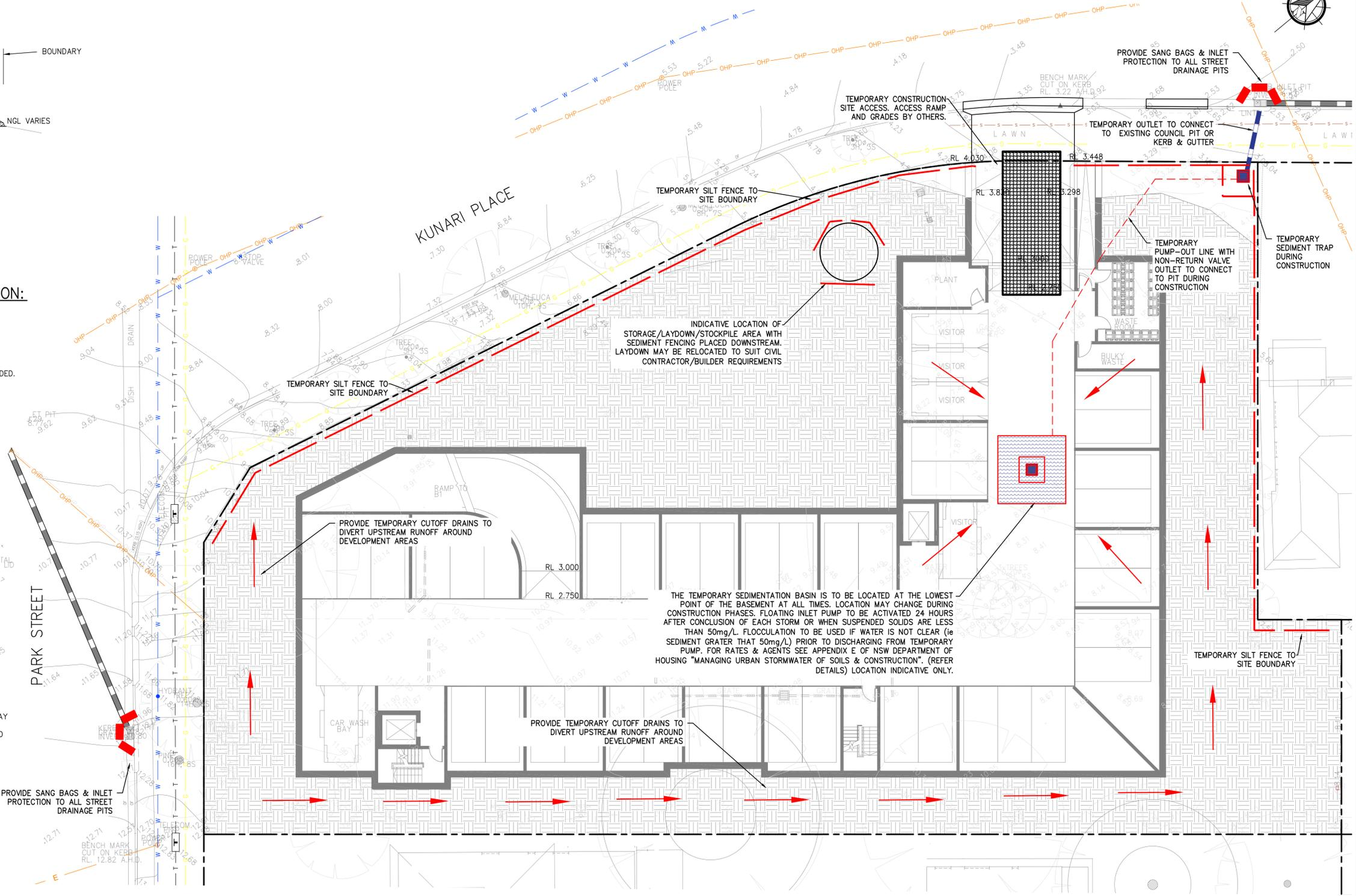
**SITE SEDIMENT & EROSION CONTROL PLAN**
