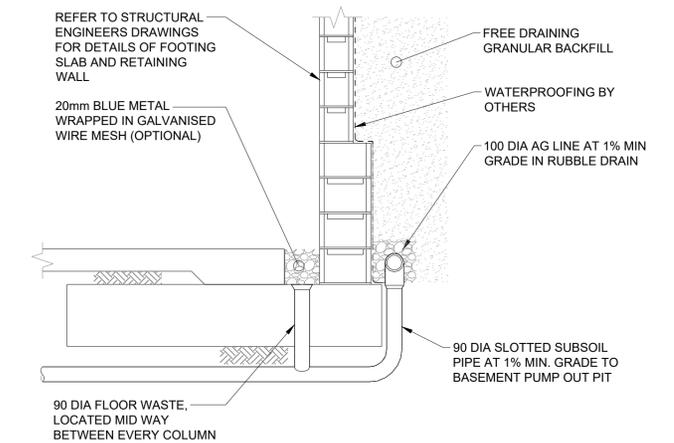
**TYPICAL GROUNDWATER DRAINAGE DETAIL**
