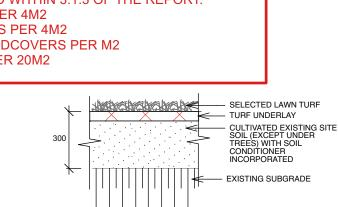
TYPICAL TURF DETAIL **SCALE 1:20**
