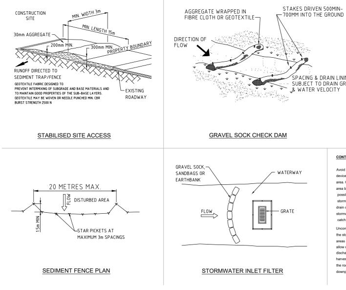
SEDIMENT & EROSION CONTROL - ADDITIONAL DETAILS TO BE FOLLOWED BY SITE MANAGER / CONSTRUCTION WORKERS
