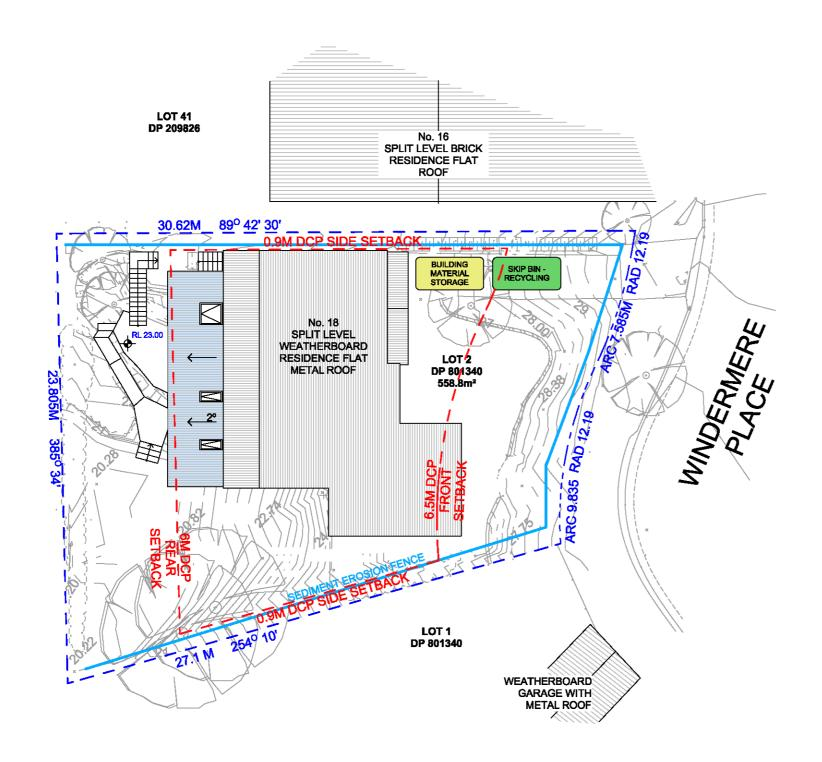
SITE / ROOF / SEDIMENT EROSION / WASTE MANAGEMENT PLAN
