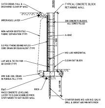
TYPICAL 1.8m BLOCK RETAINING WALL TO ROCK
