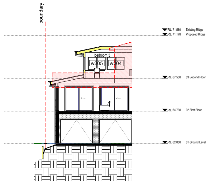
2 W206 Section - Demolition 1 : 100
