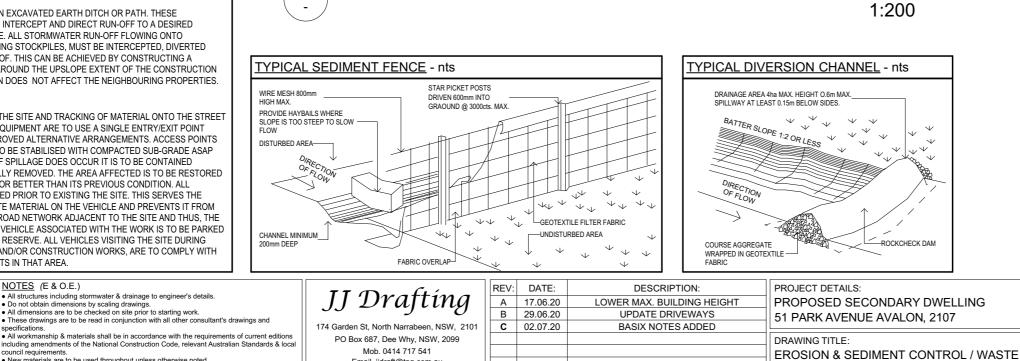
**EROSION & SEDIMENT CONTROL / WASTE MANAGEMENT PLAN**
