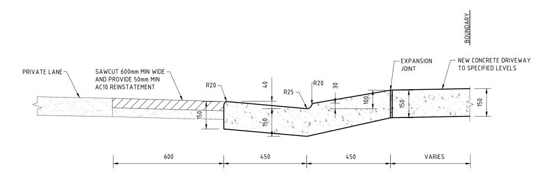
NEW LAYBACK CROSS SECTION SCALE 1:10 TYPICAL LAYBACK DETAIL
