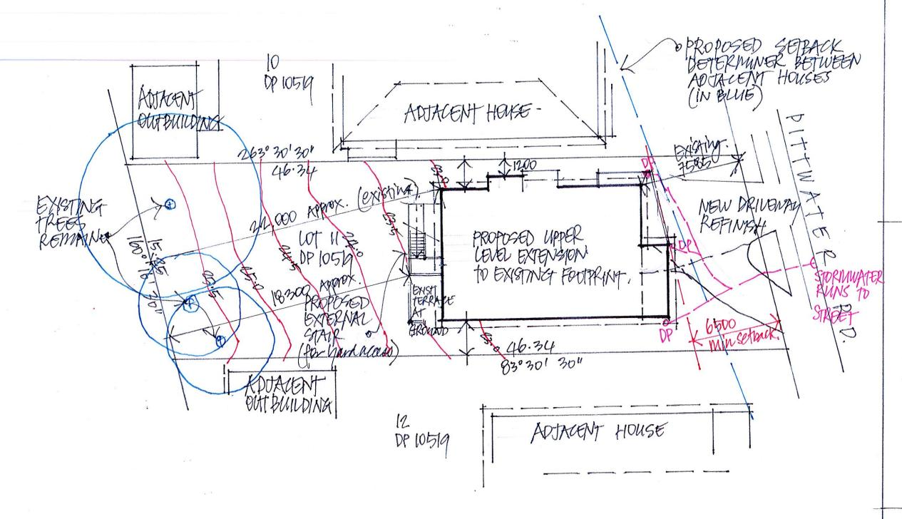
PROPOSED SITE PLAN + STORMWATER PLAN.
