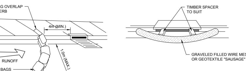
KERB INLET SEDIMENT FILTER (ON GRADE)
