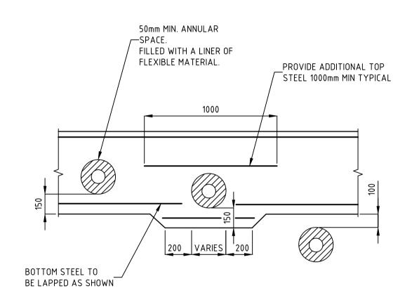
TYPICAL PIPE PENETRATION DETAIL
