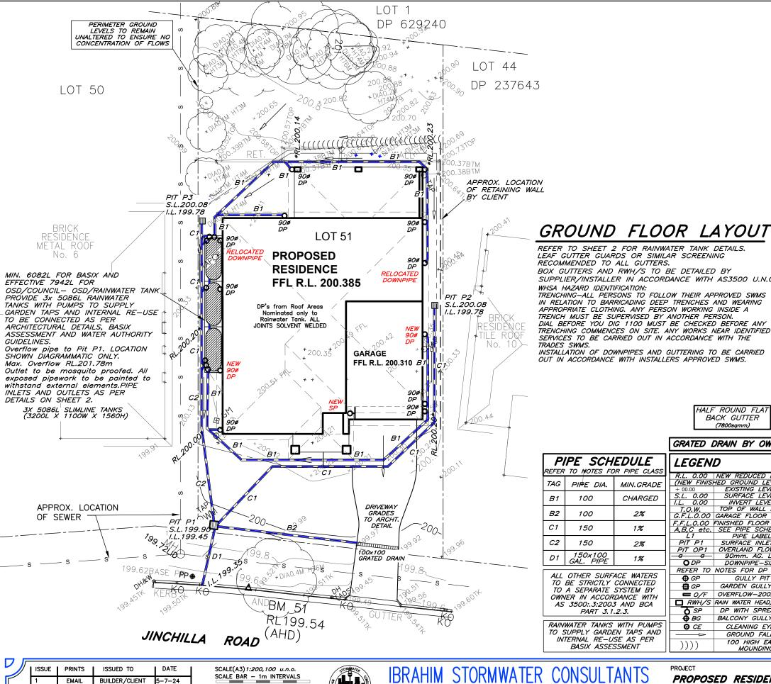
REFER TO SHEET 2 FOR RAINWATER TANK DETAILS. LEAF GUTTER GUARDS OR SIMILAR SCREENING RECOMMENDED TO ALL GUTTERS.
