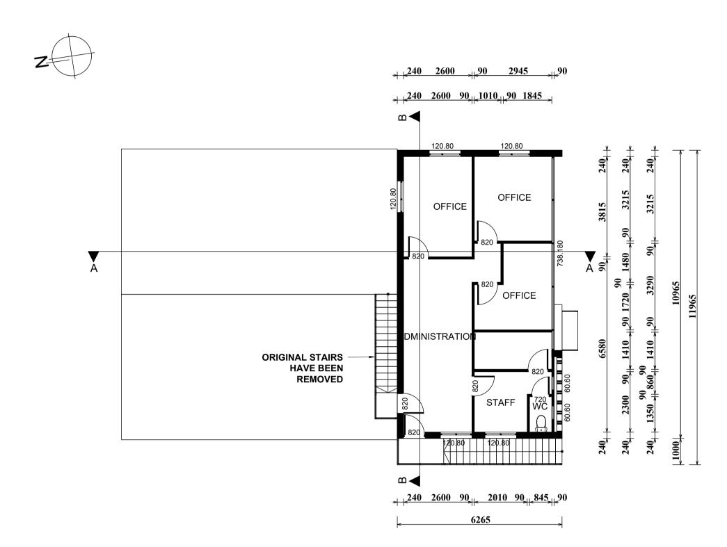
GROUND FLOOR PLAN - ORIGINAL PLAN SCALE 1:100
