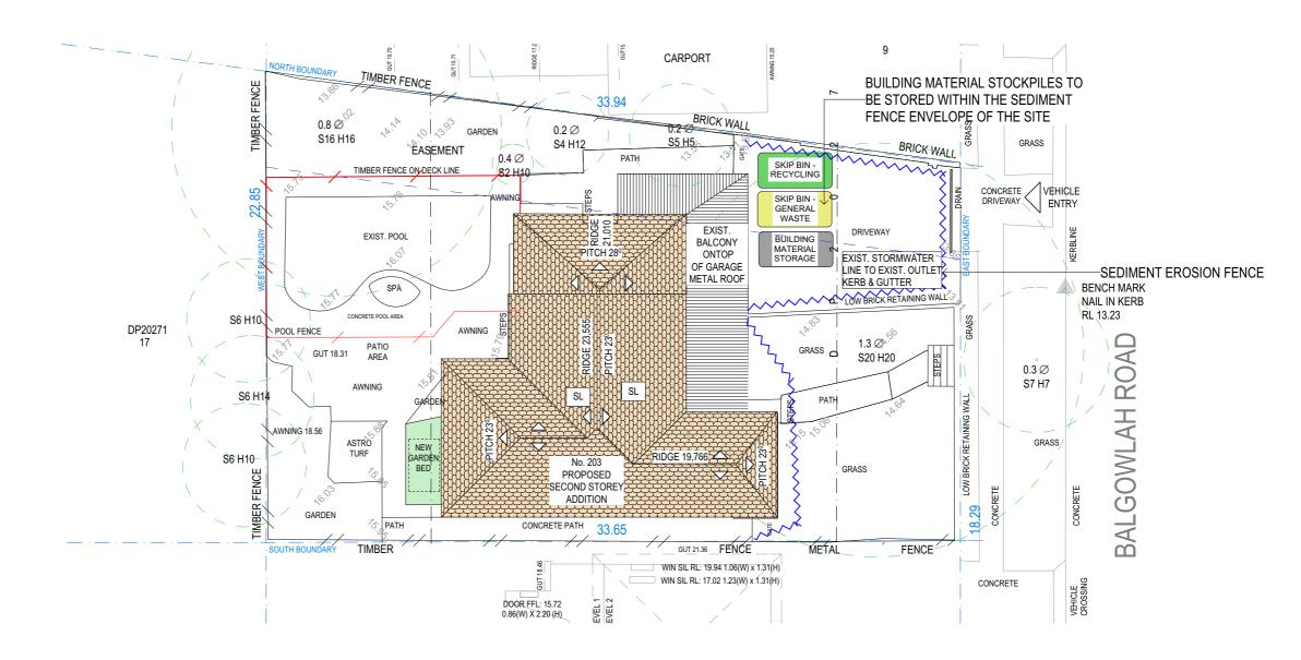
**EROSION AND SEDIMENT CONTROL & WASTE MANAGEMENT PLAN**
