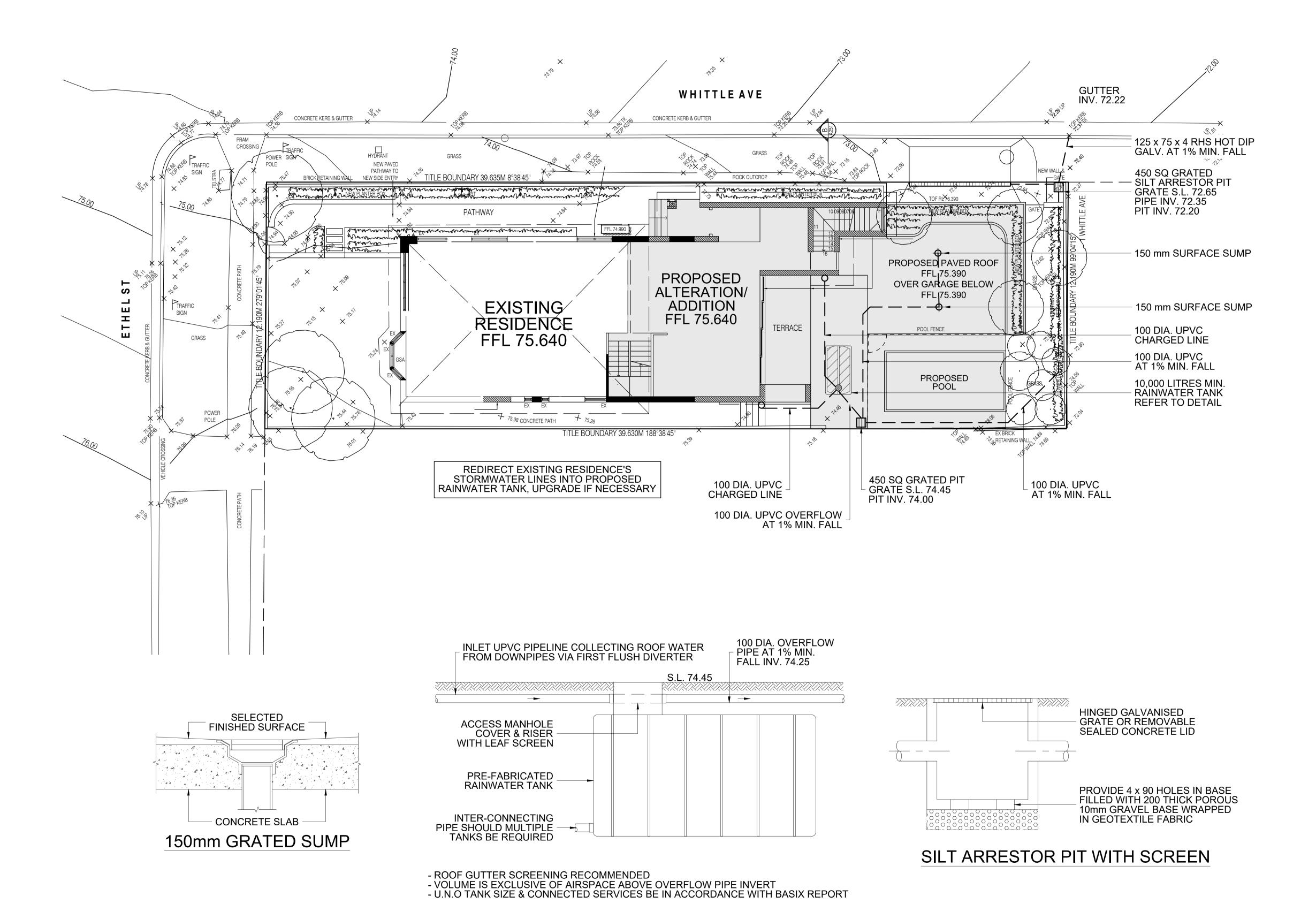
TYPICAL BELOW GROUND RAINWATER TANK
