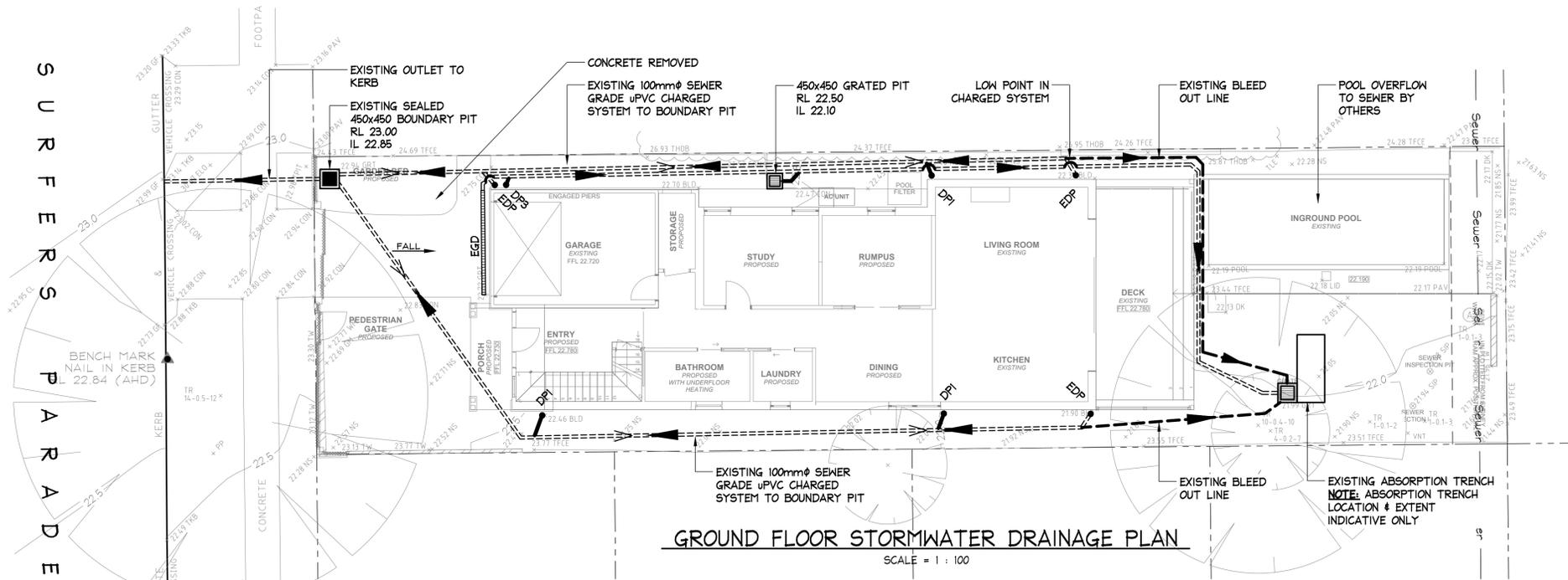
**GROUND FLOOR STORMWATER DRAINAGE PLAN**
